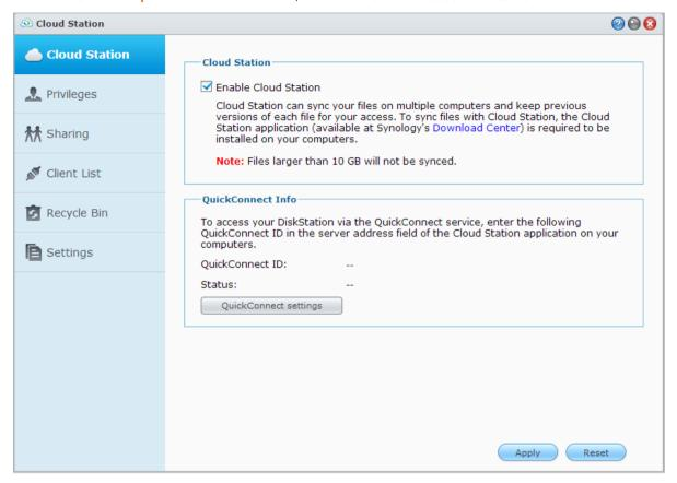
*Hinweis:* Eine Client-Applikation (Cloud Station für Computer-Clients, erhältlich im **Download-Zentrum** von Synology) muss auf den Client-Computern installiert sein, bevor Dateien mit dem Synology NAS synchronisiert werden können.
