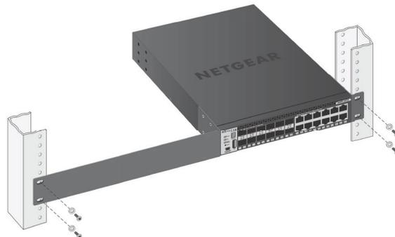
So installieren Sie zwei halbbreite Switches in einem Rack, mittlere Halterungen für innen und außen und Rackmount-Montagehalterungen werden mit den Switches geliefert:
