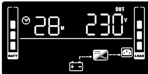
Abbildung 16: Display Batteriebetrieb
