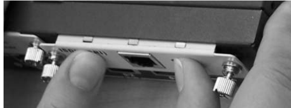
Abbildung 17: Einbauen eines Mini-PIM
