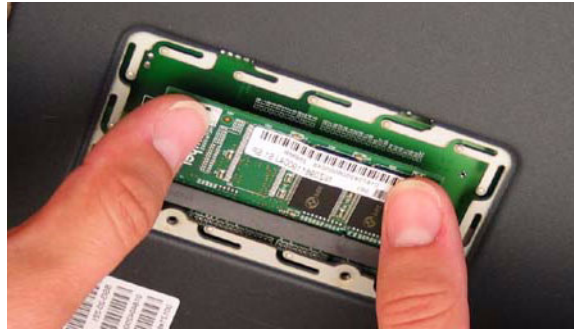
Abbildung 21: Einsetzen des Arbeitsspeichermoduls
