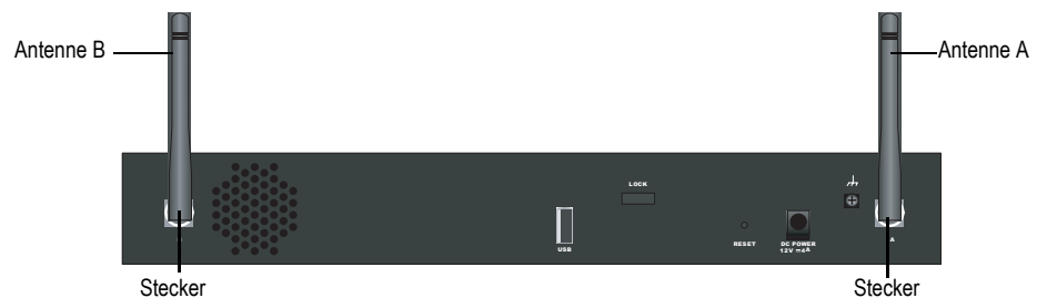
Abbildung 12: SSG 20-WLAN – Position der Antennen
